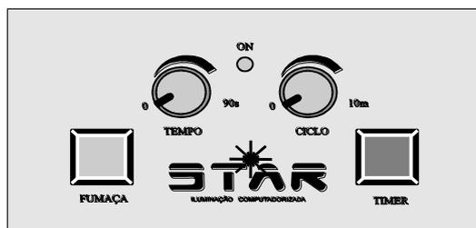
Tecla **Fumaça**: Aciona a bomba manualmente. O controle da intensidade do fluxo é feito através do potenciômetro **Fluxo** do painel traseiro.
