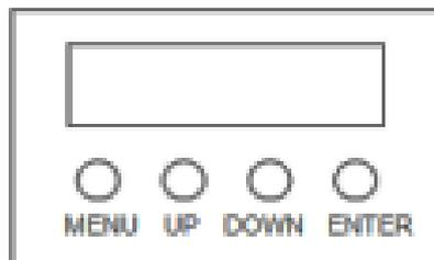
1. Pressione a tecla **MENU** para navegar entre as 9 funções de menu. Os dois primeiros dígitos indicam a função selecionada, os dois últimos indicam endereço, parâmetro e velocidade da função. Com as teclas **UP e DOWN** você pode alterar estes valores. ( a baixo segue as tabelas de funções do menu.)
